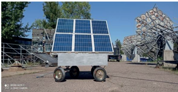
1-rasm. Mobil fotoelektrik qurilma parametrlarini Quyosh nurlari sharoitida o'lchash
